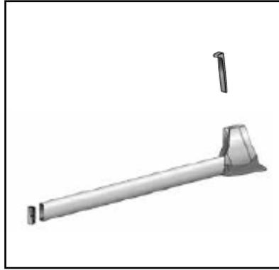
Vormontierter Ausleger, Fixierung und Höhenanpassung mit Blockierkeil
