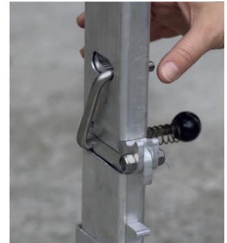
Bügel nach außen bis in letzte Kerbe drücken. Jetzt ist der Pfosten verriegelt.
