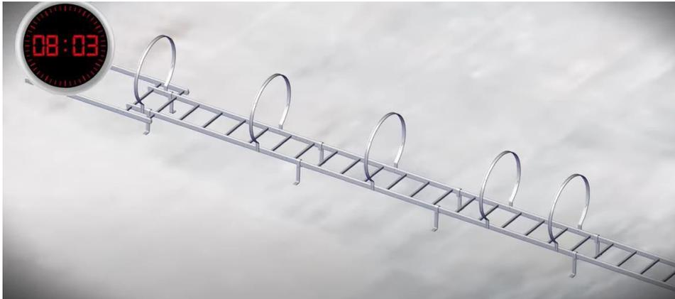
5. Die Rückenschutzstreben nach Plan zusammenfixieren. Fangen Sie an der Ausstiegsplattform mit der Montage an (F1-A, F1-B und F1-C). Fixieren Sie an den bereits montierten Streben die Streben für den unteren Teil der Leiter und befestigen sie diese ebenfalls an den Rückenschutzbügeln.
