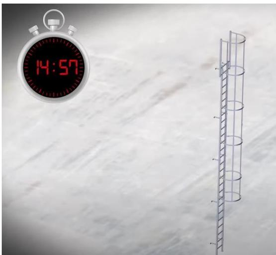
7. Bei den Berechnungen für Steigleitern mit Seitenholmen muss eine einwirkende Mindestlast von 3 kN pro Holm angenommen werden. Zudem darf davon ausgegangen werden, dass die Last über vier Verankerungsstellen auf den Befestigungsgrund (z.B. Wand) übertragen wird. Wenden Sie sich bei Fragen zum Befestigungsmittel direkt an die Hersteller.
